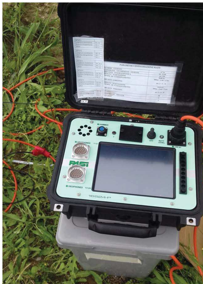
Fig. 4 - Sismografo PASI per la registrazione dei segnali sismici.
