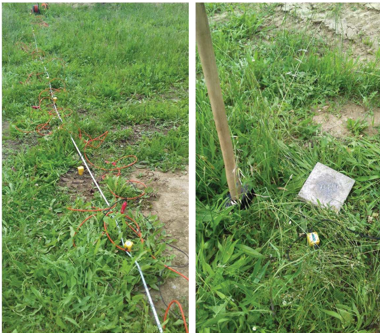
Fig. 3 - Prospezione sismica MASW effettuata sul sito oggetto di studio: sono visibili lo stendimento di geofoni e la piastra di battuta.
